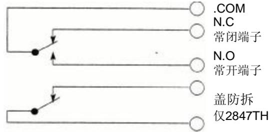
防拆线缆可以与闭合回路串联方式连接或可连接至一个独立的24小时回路。
