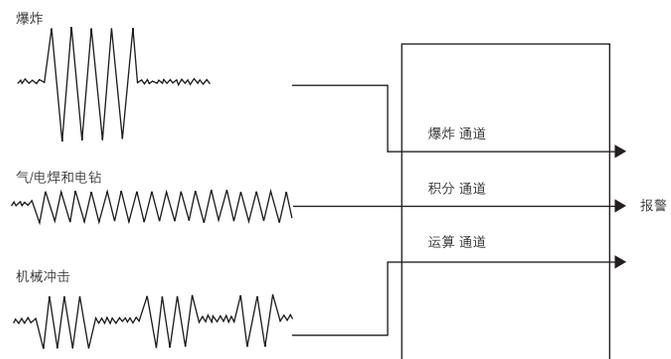
VV600特有探测分析技术，可分析三种不同频率的震动。可防止周围环境震动引起的误报。
